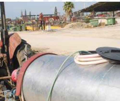
צינור מים גמיש טבול במיכל ריסוס, מהווה סכנה לזרימה חוזרת
